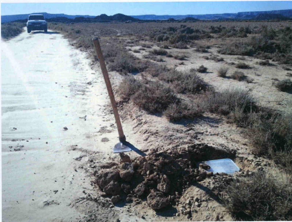
Figura 1.4. Arriba: Contador de TRAFx Vehicle Counter Generation III. Abajo: el contador ya colocado dentro del recipiente de plástico y en el hueco adyacente al camino a muestrear. (Fotos: Comunidad de Bardenas).
